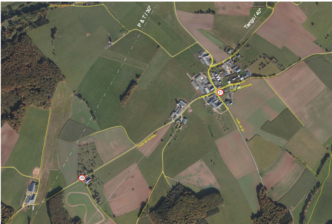
Bild 1: Luftbild des Ortsteils Michelbouch der Gemeinde Vichten mit den Hauptstrahlrichtungen P&T / 30° und Tango / 40° der Basisstationen am lokalen Mast in Vichten sowie mit den Messpunkten MP 20 und MP 21. Die übrigen Hauptstrahlrichtungen des Mastes in Vichten liegen außerhalb von Michelbouch.
